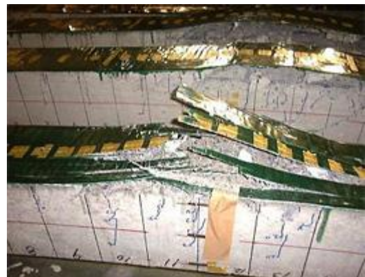
曲げ試験によるシート破断状況
