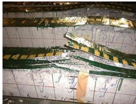
曲げ試験によるシート破断状況
