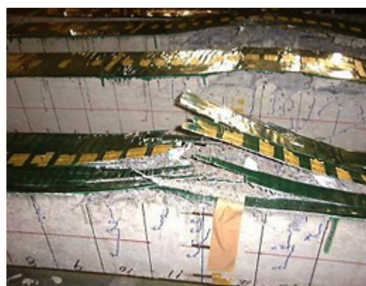
曲げ試験によるシート破断状況
