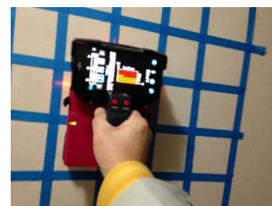
配筋調査(非破壊探査)
